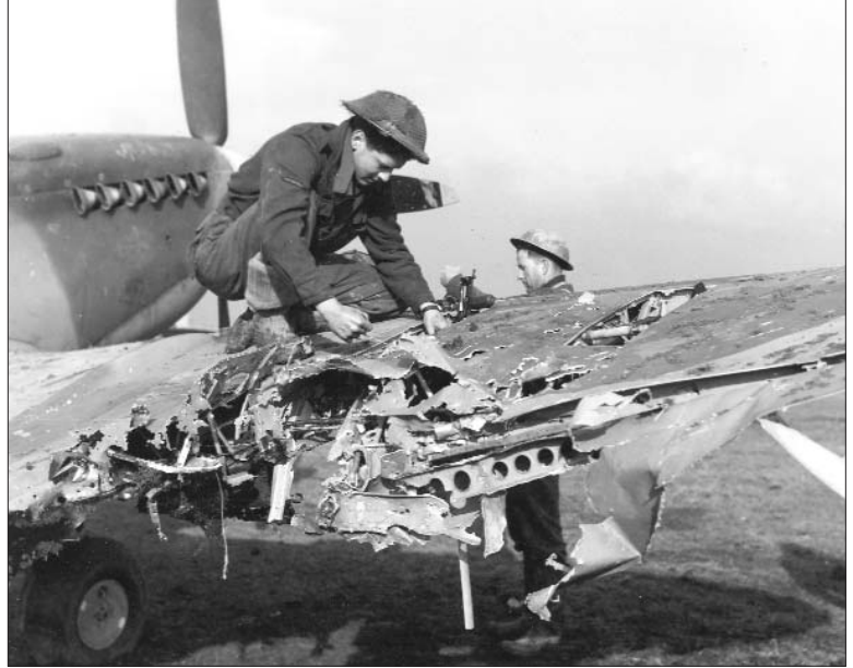
Réparation d'impacts d'artillerie antiaérienne sur un Spitfire Mark IV en Hollande, 1944.
