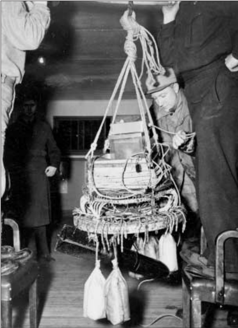
Le lustre (nom donné au panier suspendu sous le ballon) du ballon forcé d'atterrir près de Coal Harbour a été retrouvé intact. La photo montre les dimensions des sacs de sable et de l'équipement que transportait le ballon. Ce lustre contient la petite cible sur laquelle les pilotes avaient ordre de tirer pour ne pas endommager le ballon.
